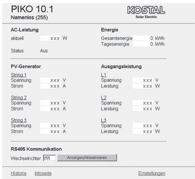
Figur 93: Webserverens hovedside (antallet af viste ind- og udgange kan variere afhængigt af apparattypen.)
