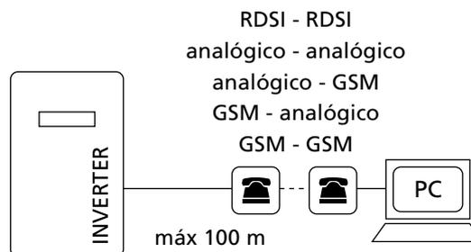
1. Conecte su Solar Inverter al módem remoto mediante un cable Ethernet CAT5 1:1 con hembras RJ45.
