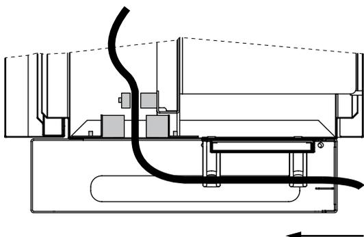
4. Abra el dispositivo antitracción y pase el cable.
