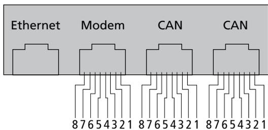
Los conectores para las interfaces CAN IN, CAN OUT y módem tienen la siguiente asignación de los pines:
