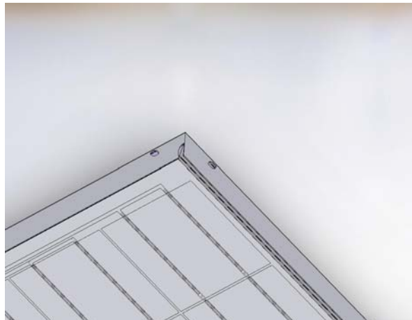
Imagen 2 Orificios de Drenaje
